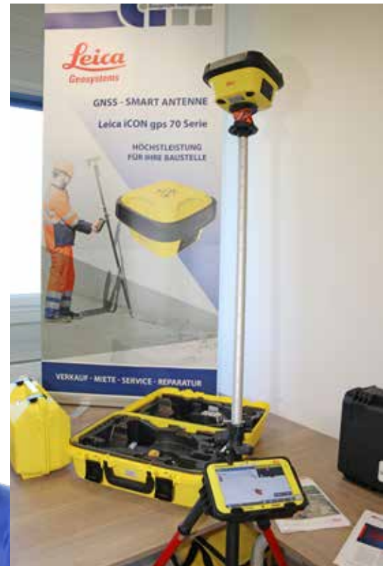
Auf großes Interesse stieß auch die GNSS-Satellitenantenne Leica iCON ICG70T, mit der eine Messung bei jeder Neigung des Messstabes möglich ist.
